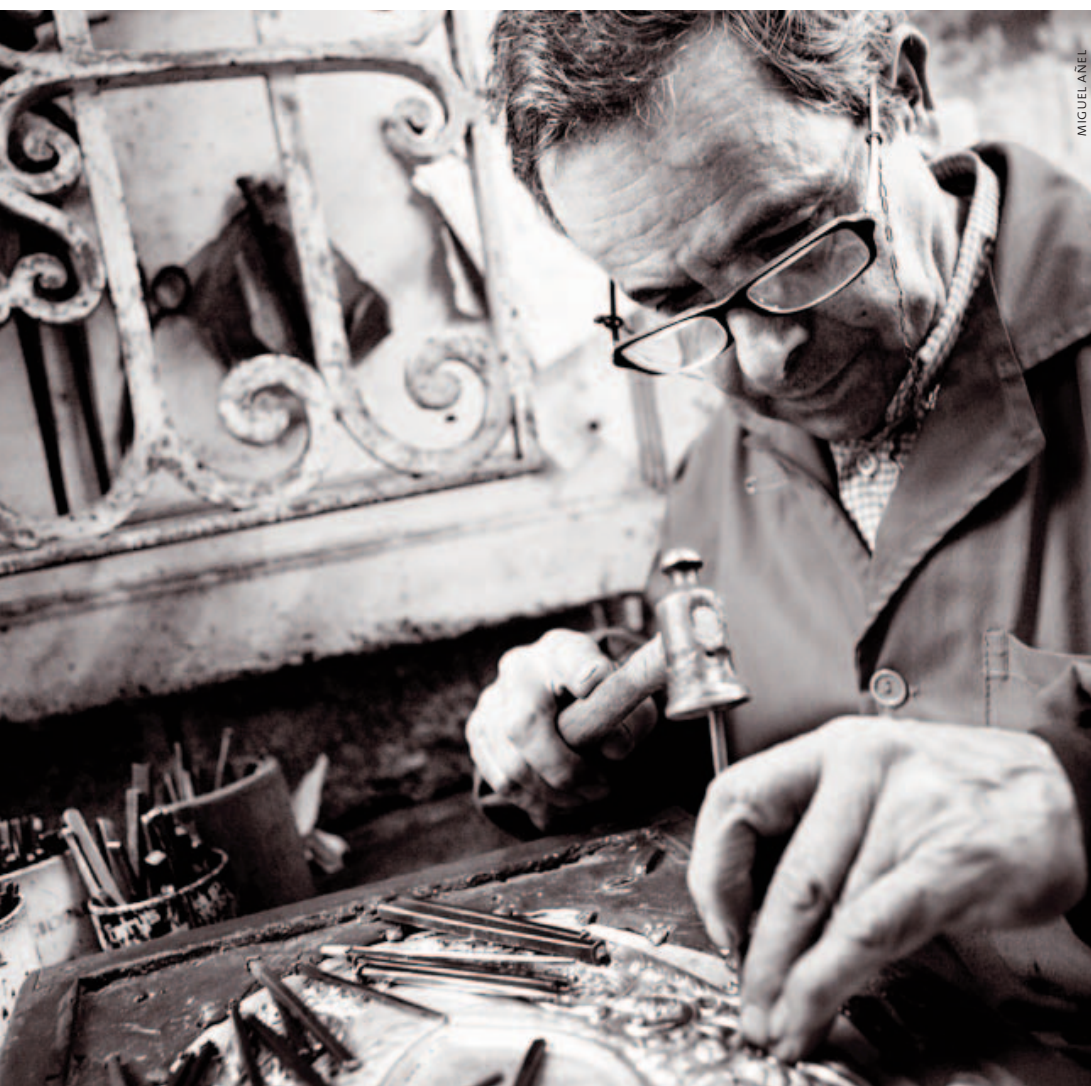
O artesán Julio Lado repuxando unha bandexa de prata. | El artesano Julio Lado repujando una bandeja de plata.
